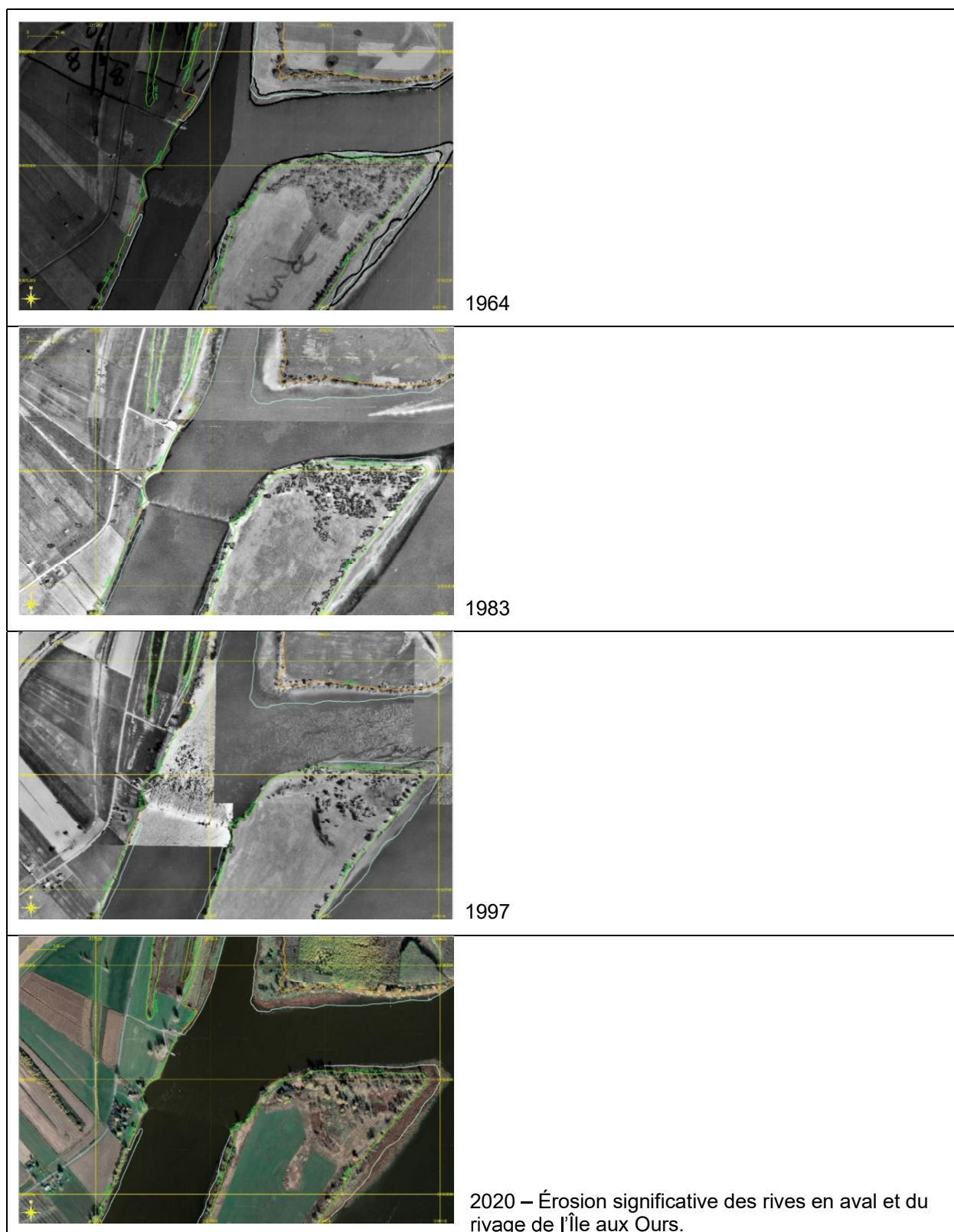
Figure 4.13 Photos aériennes montrant l'érosion près du reversoir 3
